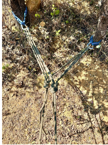
Resim 3.5. Çift Kulak Sekizli Düğümü İle İstasyon Kurulumu
