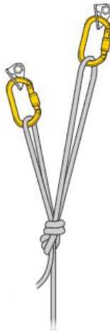
Resim 3.5. Çift Kulak Sekizli Düğümü İle İstasyon Kurulumu
