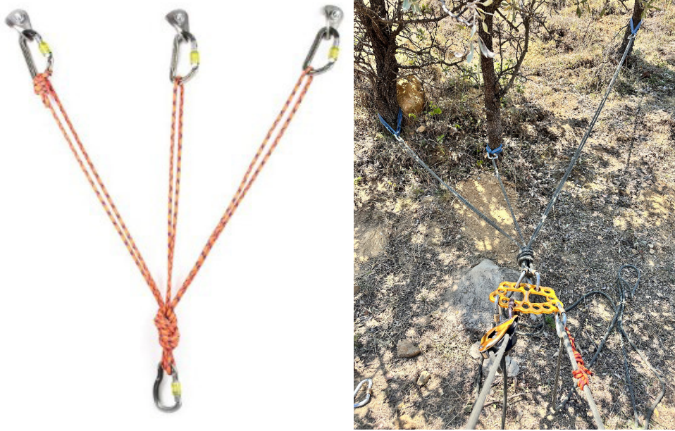
Resim 3.7. Üç ve Üzeri Emniyet Noktasından Örümcek Çapası İstasyonu Kurulumu
