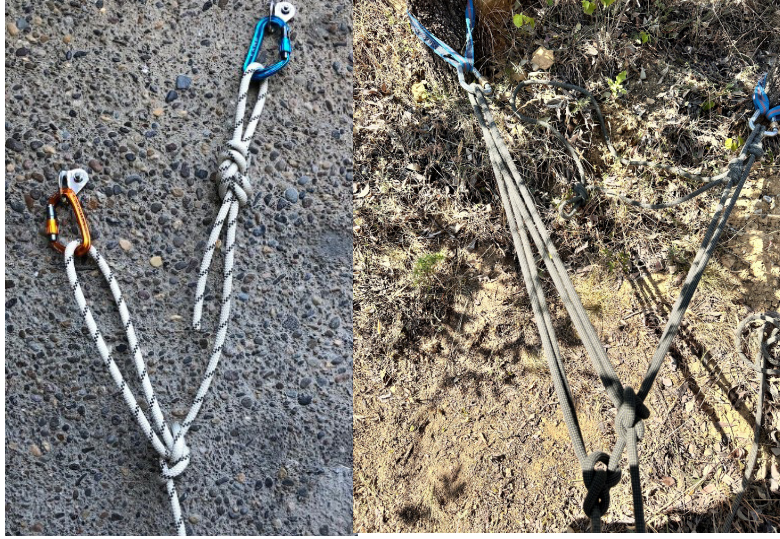
Resim 3.6. Sekizli Düğümü ve Kelebek Düğümü İle İstasyon Kurulumu
